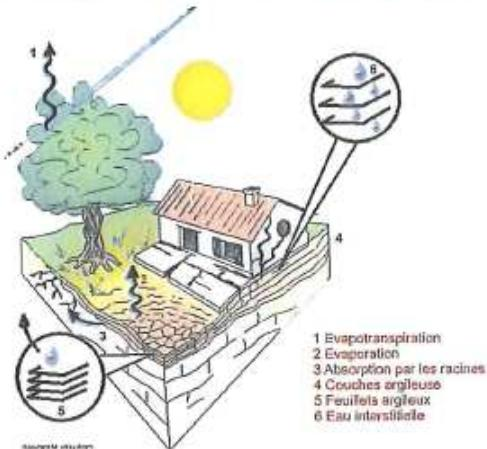
Un sol argileux change de volume selon son humidité comme le fait une éponge : il gonfle avec l'humidité et se resserre avec la sécheresse, entraînant des tassements verticaux et horizontaux, des fissurations du sol.
