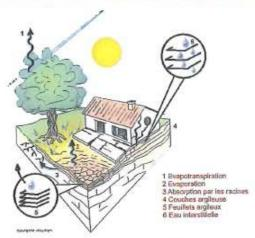
Un sol argileux change de volume selon son humidité comme le fait une éponge ; il gonfie avec l'humidité et se resserre avec la sécheresse, entraînant des tassements verticaux et horizontalement, des fissurations du sol.
