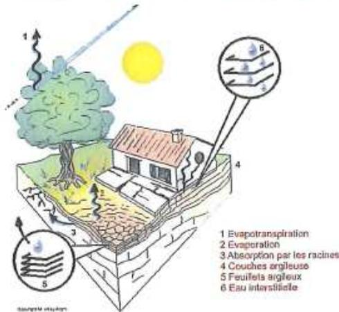
Un sol argileux change de volume selon son humidité comme le fait une éponge ; il gonfle avec l'humidité et se resserre avec la sécheresse, entraînant des tassements verticaux et horizontalement, des fissurations du sol.
