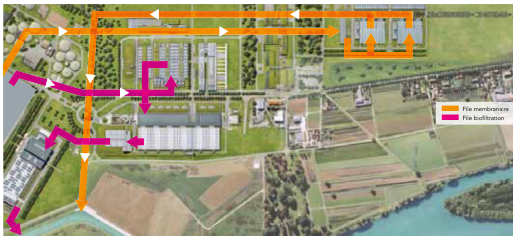
Répartition de l'eau sur les 2 files de traitement biologique
